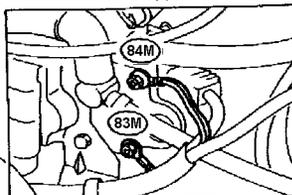
**Заземление на двигатель**
