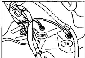
**Заземление на двигатель**
